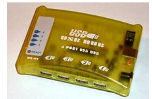
4-Port-USB-Hub mit eigener Stromversorgung ( self powered , Netzteilbuchse rechts)
