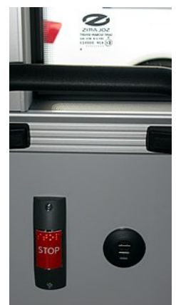
USB-Ladesteckdose im Solaris Urbino 12 electric
