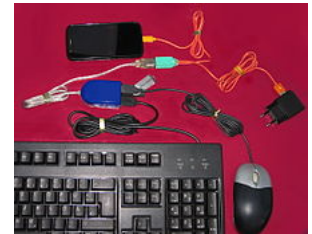
USB-OTG-Anordnung eines Android-Smartphones mit angeschlossenen USB-Stick und PC-Tastatur und -Maus. Zusätzlich ist eine externe Stromversorgung angeschlossen.
