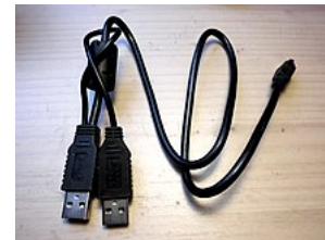
USB-Y-Kabel 2 Stecker Typ A auf Stecker Mini Typ A zum Anschluss einer externen Festplatte an zwei USB-2.0-Buchsen
